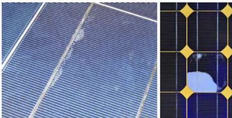
Fig. 25 Deslaminación en barra colectora del panel.
