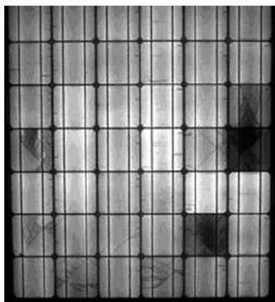
Fig. 26 Fotografía de un módulo con micro-fisuras y fracturas en celdas.
